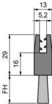
Para el espesor de chapa 3 - 4 mm
