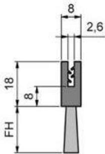
Para el espesor de chapa 0,6 - 1,5 mm
