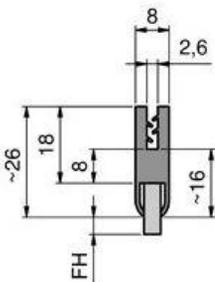
Para el espesor de chapa 0,6 - 1,5 mm
