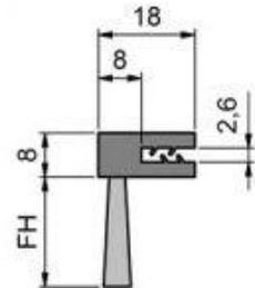
Para el espesor de chapa 0,6 - 1,5 mm
