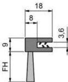
Para el espesor de chapa 1,5 - 2 mm
