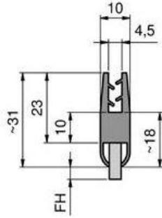
Para el espesor de chapa 1,6 - 3 mm
