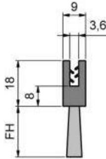
Para el espesor de chapa 1,5 - 2 mm
