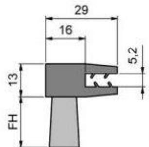
Para el espesor de chapa 3 - 4 mm
