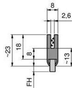
Para el espesor de chapa 0,6 - 1,5 mm
