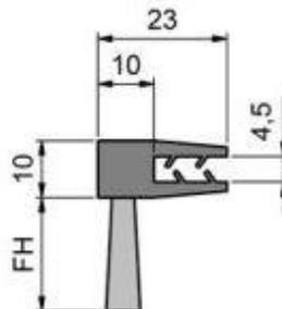
Para el espesor de chapa 2 - 3 mm
