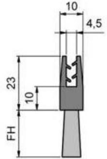
Para el espesor de chapa 2 - 3 mm
