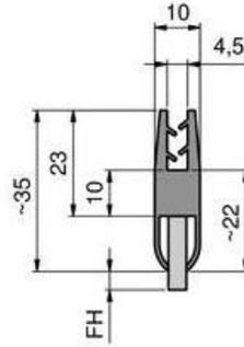
Para el espesor de chapa 1,6 - 3 mm
