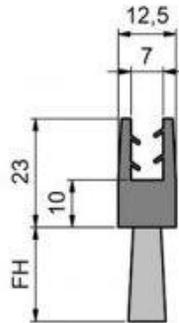
Para el espesor de chapa 5 - 6 mm
