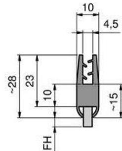
Para el espesor de chapa 1,6 - 3 mm
