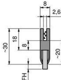
Para el espesor de chapa 0,6 - 1,5 mm
