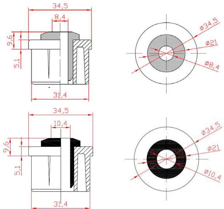
**BUJE PARA TUBO METÁLICO DE 1,5 MM.**
