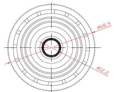
**BUJE PARA TUBO METÁLICO DE 1,5 MM.**
