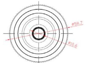
**BUJE PARA TUBO METÁLICO DE 1,5 MM.**
