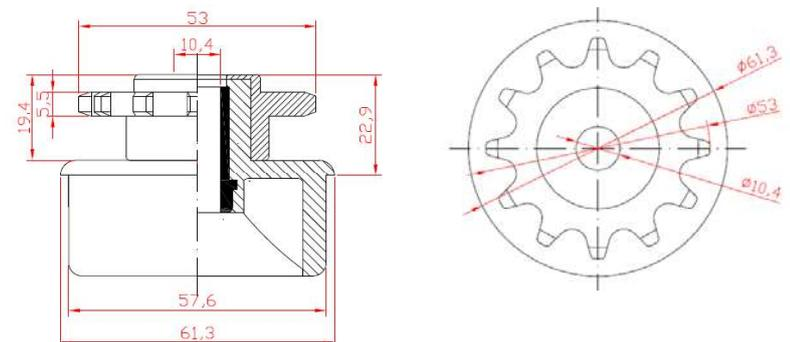
**BUJE PARA TUBO METÁLICO DE 1,5 MM.**
